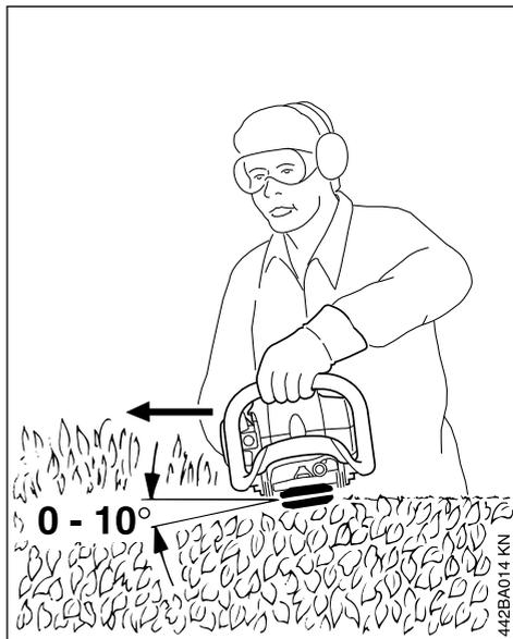
Posicionar a lâmina de corte num ângulo de 0° até 10°, mas conduzir a máquina na horizontal.
