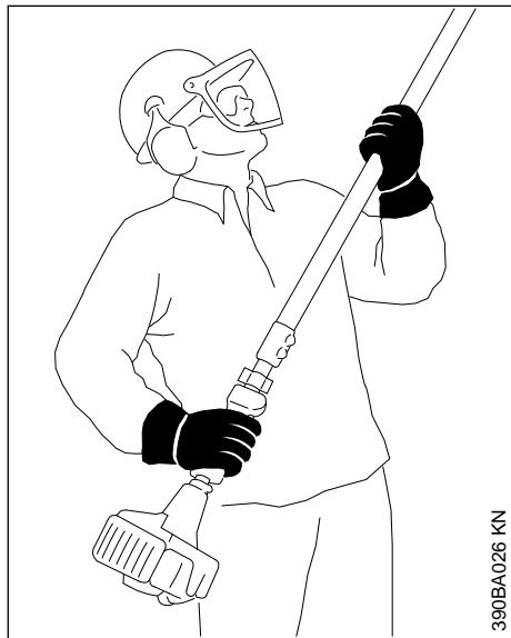
Para um manejo seguro, sempre conduzir a máquina, **segurando-a com as duas mãos**. Mão direita no cabo de manejo e mão esquerda no tubo do eixo, mesmo para canhotos. Envolver o cabo de manejo e o tubo do eixo firmemente com os polegares.
