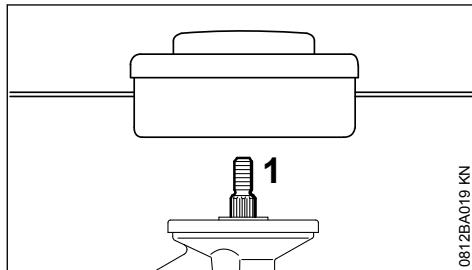
Montar somente cabeçotes de corte, que podem ser fixados diretamente no eixo (1).
