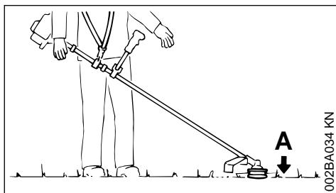
Ferramentas de corte (A) como cabeçotes de corte, lâminas para cortar relva e lâminas de metal:
