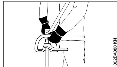
Nos modelos com cabo circular e cabo circular com haste (limitadora do passo): mão esquerda
