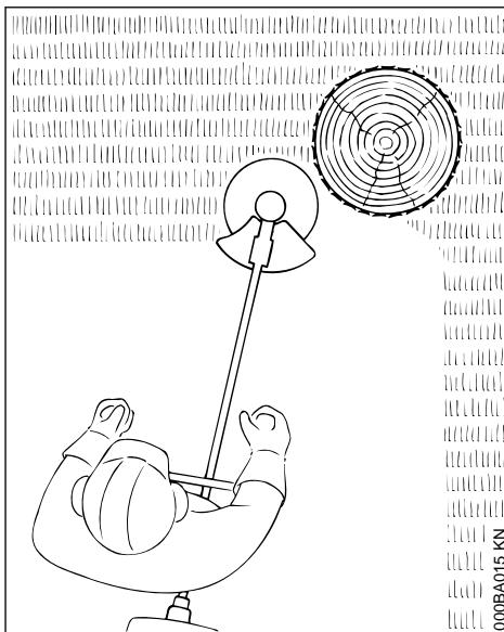
Indicado para corte "macio" e para cortes em volta de árvores e postes. Menos perigo de ferir a casca da árvore.
