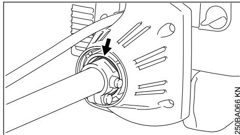
Entre a unidade motora e o tubo está instalado um elemento de borracha, para amortecimento de vibrações. Se houver desgaste ou se as vibrações aumentarem perceptivelmente, levar a máquina para verificação em uma assistência técnica.
