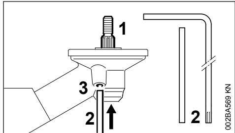
Para fixar e soltar a ferramenta de corte, o eixo (1) deve ser bloqueado com o pino fixador (2) ou com a chave de fendas angular (2). As peças estão incluídas no pacote de fornecimento ou podem ser adquiridas como acessório especial.
