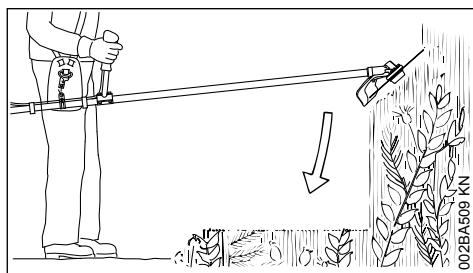
"Mergulhar" a lâmina de metal no matagal e brecha, que será triturada (cortada em partes). Não erger a ferramenta de corte acima da cintura.
