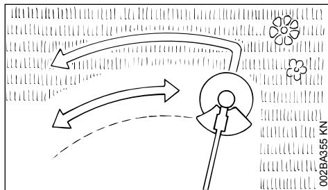
Ao cortar grama e ao podar brotos novos, conduzir a máquina como uma foice bem próxima ao solo.
