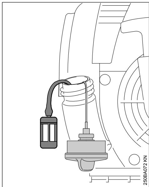
Substituir o cabeçote de aspiração do combustível regularmente, para isso:
