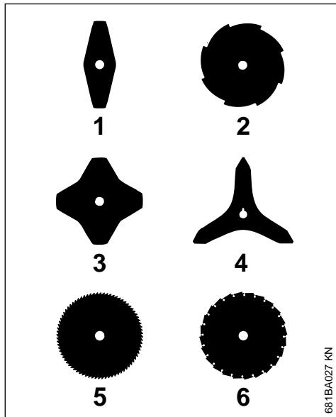
Nas ferramentas de corte com 2, 3 ou 4 pontas (1, 3, 4) os gumes podem apontar na direção desejada. Virar as ferramentas de corte regularmente, para evitar desgaste unilateral.
